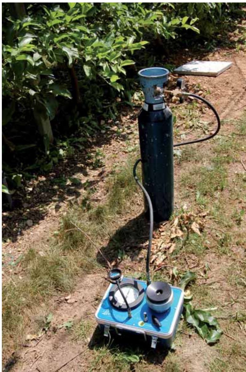
Camera a pressione per la misura del potenziale idrico fogliare su melo (Trentino)
